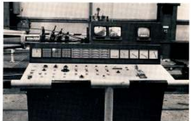
▶ Bild 7: Der Preßlagerandruck und die Litzenspannungen sind am Steuerpult kontrollierbar und einstellbar
