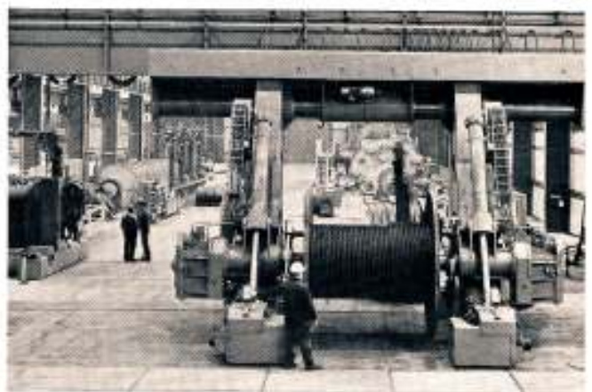
▶ Bild 9: Rotierende Abwickler und traversierende Aufwickler
