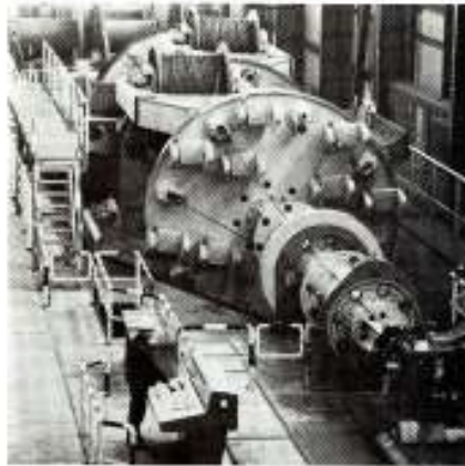
◀ Bild 6: Eine ausreichende Spulenkapazität macht es möglich, Seile für Mehrseilförderanlagen in einer Länge herzustellen
